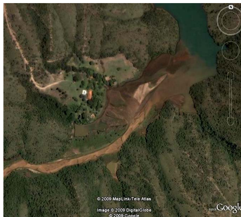
Figura 32: Imagem de satélite (Google 2009) mostrando a foz do Ribeirão Lajeado, com intenso assoreamento do braço da represa.
