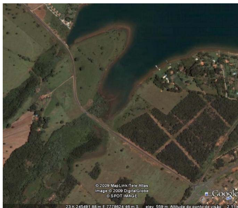
Figura 34: Imagem de satélite (Google, 2009) da foz do Córrego Casa Branca, mostrando o intenso assoreamento do braço do Reservatório.
