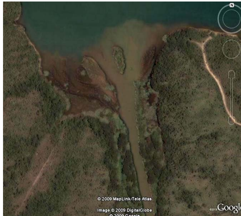
Figura 31: Imagem de satélite (Google 2009) mostrando a foz do Ribeirão Bom Jesus provocando intenso assoreamento no braço do Reservatório Jaguará.
