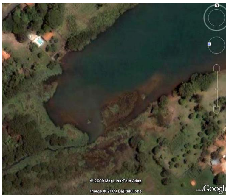
Figura 33: Imagem de satélite (Google, 2009) da foz do Córrego do Cervo, mostrando o intenso assoreamento do braço do Reservatório.
